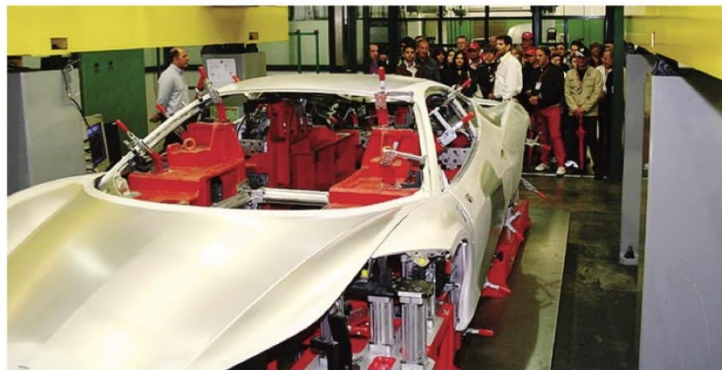
Una fase produttiva delle scocche in alluminio della Ferrari. Il gruppo caloziese occupa in totale un migliaio di addetti
