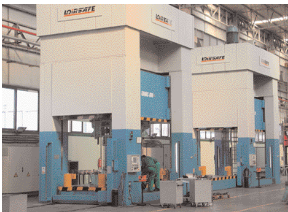
Reparto presse: quando lo stampo arriva alla pressa, lo stampista vero e proprio provvede alla messa a punto e alla finitura, con tanto di manualità
